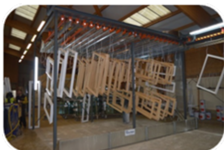
Aufspeicherlager der Traversen
